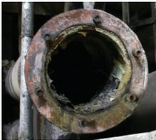
**Tubería metálica mostrando corrosión interna y externa.**
